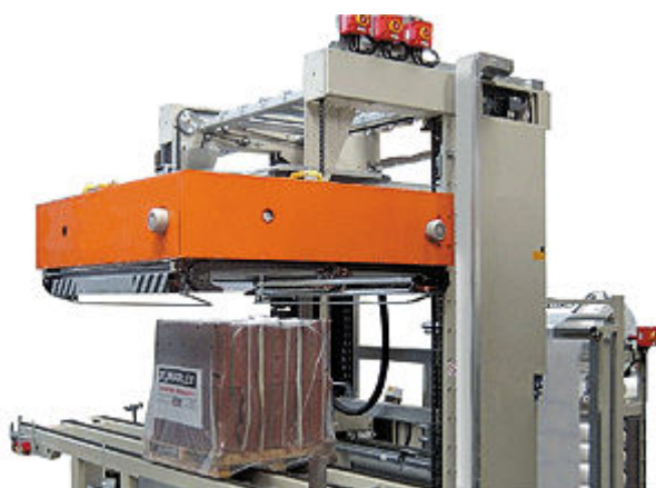
Mod. LIGO-DUO AT 53 Incappuciatrice automatica con termoretrazione ad aria calda
